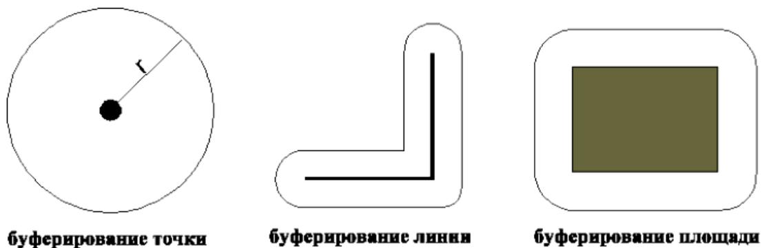
Рис.2.12. Построение буферных зон заданной ширины для различных графических примитивов.
